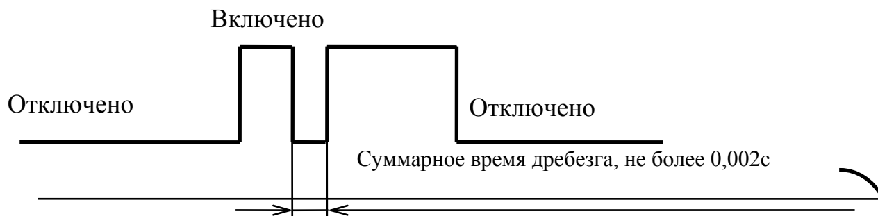
Рисунок А.1 - Схематическая осциллограмма контроля времени дребезга контактов
